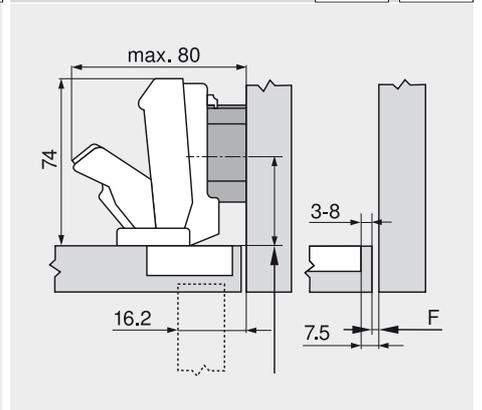
Poziția de fixare a plăcuței de montaj se mută spre spate cu grosimea ușii + 1.5 mm
